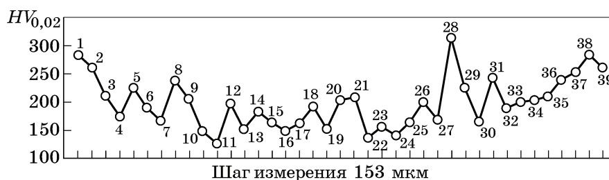
Фиг. 8. Распределение микротвердости по сечению образца П-3 (СЛП-сталь 03X18H12M2T +ХИП)
