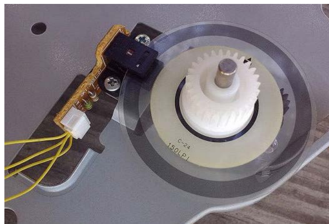
Fotografia 14. Zespół precyzyjnego enkodera inkrementalnego drukarki, złożony z modułu transpatora szczelinowego oraz tworzywowej tarczy z naniesionymi znacznikami optycznymi ( https://t.ly/CF6v )
