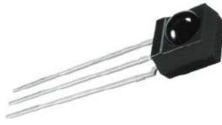
Fotografia 10. Odbiornik podczerwieni TSSP4P38 ( https://t.ly/C_fqF )
