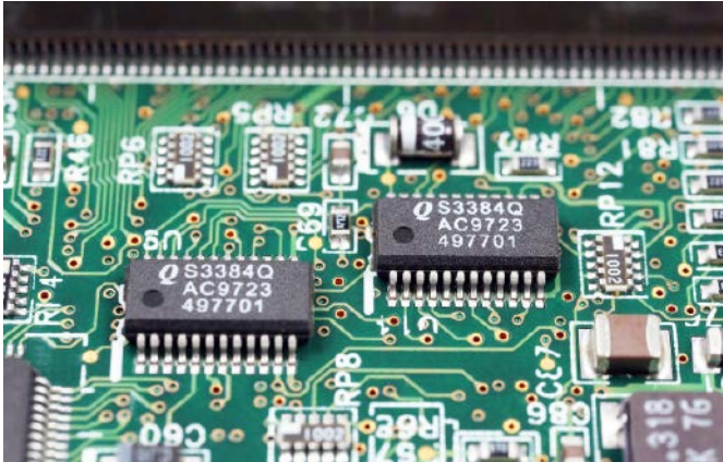
Fotografia 1. Zorientowane w tę samą stronę układy scalone na płytce PCB
