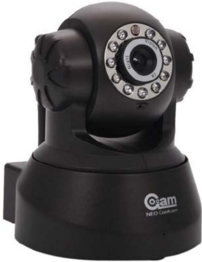
Fotografia 2. Przykładowa kamera IP z oświetlaczem podczerwieni i czujnikiem zmierzchowym, bazującym na fotorezystorze (widoczny nad obiektywem) – https://t.ly/iRhI
