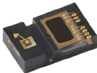
Fotografia 8. Czujnik odległości VCNL36825T marki Vishay ( https://t.ly/zo90L )
