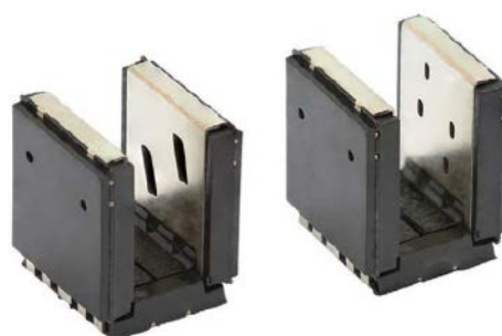
Fotografia 16. Miniaturowe transporthy szczelinowe typu TCUT1800X01, przeznaczone do budowy 4-bitowych enkoderów absolutnych ( https://t.ly/9l7Vc )
