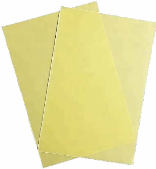
Fotografia 2. Surowe prepregi przed procesem laminacji PCB
