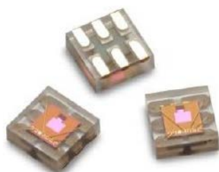
Fotografia 3. Czujniki APDS-9306-065 marki Broadcom ( https://t.ly/f8Tj )
