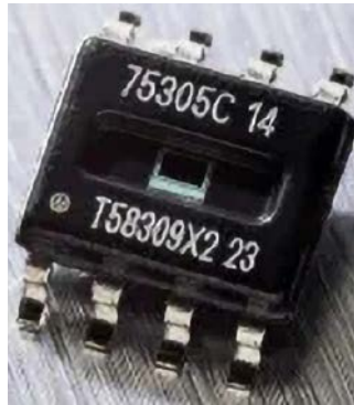
Fotografia 1. Czujnik MLX75305 marki Melexis (https://t.ly/D2AS)
