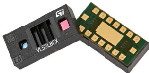
Fotografia 20. Zaawansowane czujniki ToF – VL53L8CX ( https://t.ly/x_5a )
