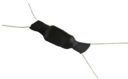
Fotografia 3. Transoptor zbudowany na bazie fotorezystora, przeznaczony do wzmacniaczy gitarowych ( https://t.ly/0cyk )
