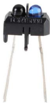
Fotografia 12. Transpotor odbiciowy TCRT5000 ( https://t.ly/8HEG )
