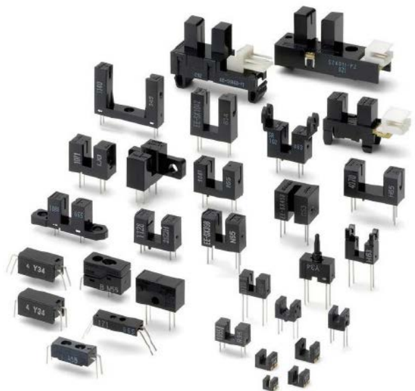
Fotografia 10. Różne modele transoptorów odbiciowych i szczelinowych ( https://t.ly/jrZW )
