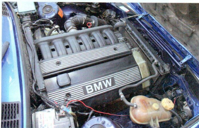
A hatalmas, 2,5 literes motor éppen befért. 192 lóerővel indul a képlet
