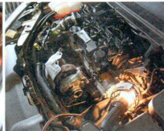
A turbóról lebontják a csöveket, így ellenőrizve a fizikai állapotot
