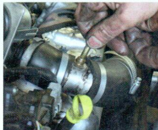
Az eredeti helyére szerelt spéci légcső a leágazással
