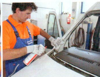
Ragasztás előtt zsírtalanítják az üvegeket és a szélvédőkeretet is
