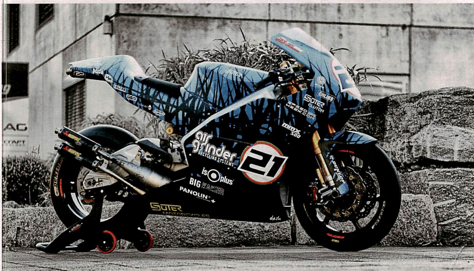
Bereit für den Beginn ihrer Karriere als Rennmotorrad: Die Suter MMX 500 mit 588ccm-V4-Zweitakt-Einspritzmotor in ihrer Kriegsbemalung für die Tourist Trophy 2016
