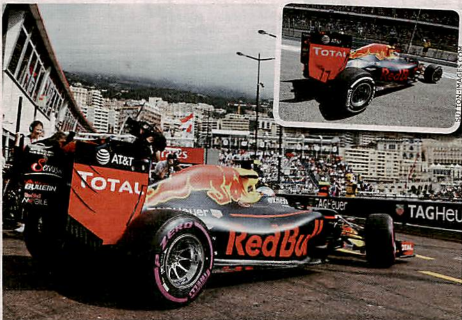
Filigrane Lamellen statt zwei großer Schlitz: Red Bull änderte in Monaco die Heckflügel-Philosophie
