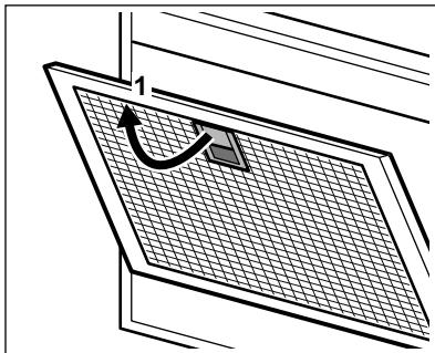
2. Reinigen Sie die Filter mit einem Schwamm und nicht-scheuerndem Reiniger oder in der Spülmaschine.
