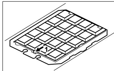
3. Uue filtrti paigaldamiseks teostage toiming vastupidises järjekorras. Kindlasti tuleb filtrid välja vahetada vähemalt iga nelja kuu tagant.
