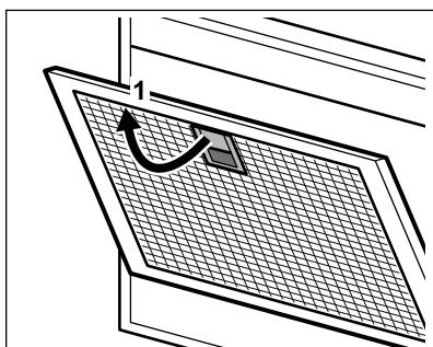
2. Filtre očistite z gobico in čistilnim sredstvom, ki ni grobo, ali v pomivalnem stroju.
