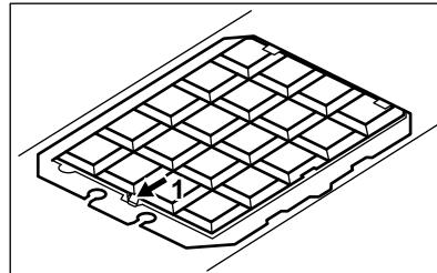
3. Asenna uusi suodatin suorittamalla toimenpiteet päinvastaisessa järjestyksessä. Suodattimet on joka tapauksessa vaihdettava vähintään neljän kuukauden välein.
