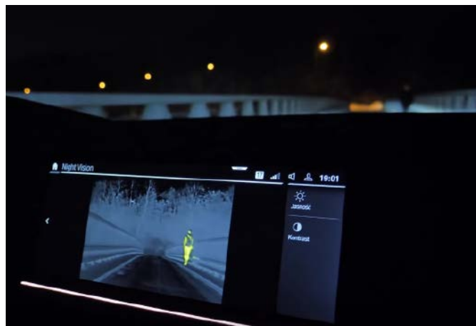
Fotografia 15. Przykład działania systemu Night Vision w nowoczesnym samochodzie marki BMW. Warto zwrócić uwagę na funkcję automatycznego rozpoznawania obrazu, która umożliwiła wyróżnienie sylwetki pieszego kolorem żółtym na tle szarego tła ( https://t.ly/3GZ2 )
