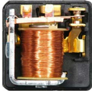
Fotografia 14. Prosty przełącznik, w którym izolacja pomiędzy cewką a stykami bazuje głównie na odstępach powietrznych i powierzchniowych (nie licząc izolacji stałej pomiędzy rdzeniem cewki a jej uzwojeniem) – https://t.ly/SF-O
