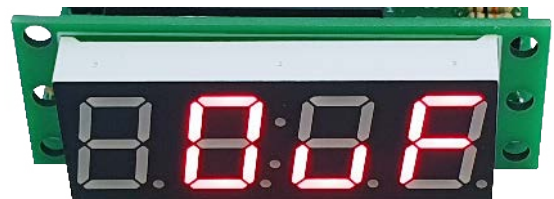
Fotografia 3. Sposób sygnalizacji przepełnienia licznika
