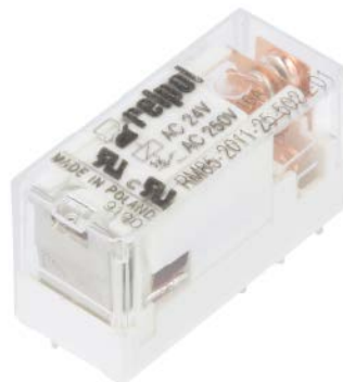
Fotografia 2. Przełącznik miniaturowy typu RM85201125502401. Wybrane modele przełączników umieszczono w przezroczystych korpusach
