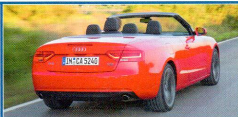
Négyféle színben rendelhető a vászontető. Akár 50 km/órás tempóig, 15 mp alatt „levetkőzik” a kabrió
