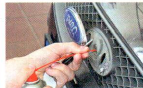
A zárbetét aktív olajjal tisztítható-kenhető
