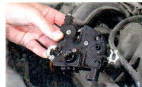
A zárszerkezetet jobb kiszerezni és úgy kitisztítani
