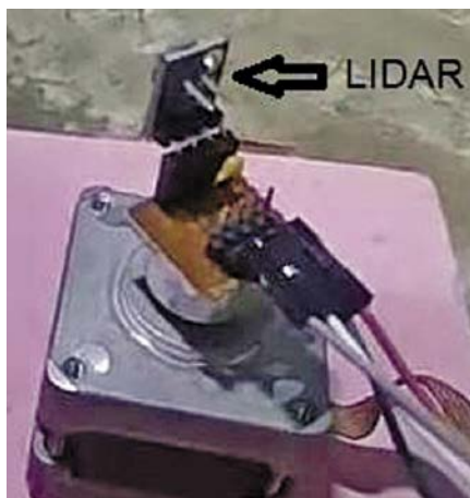
Rysunek 2. Moduł LIDAR umocowany na osi silnika krokowego
