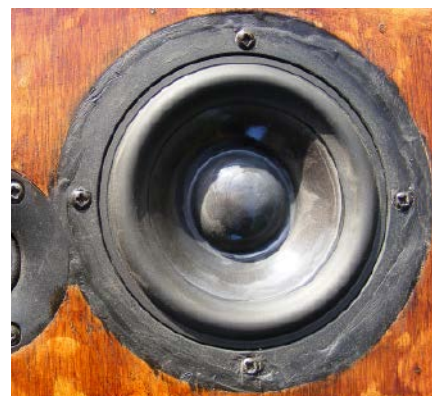
Rysunek 6. Głośnik niskotonowy Wavecork WF120BD06 do mini-monitora PE oraz front głośnika niskotonowego Wavecork zamontowany w skrzyni (proszę zwrócić uwagę na membranę z dopingiem).
