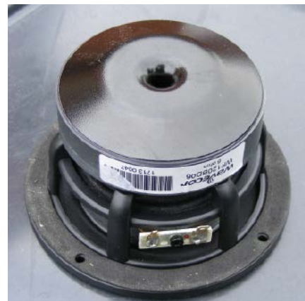
Rysunek 7. Widok tyłu głośnika niskotonowego Wavecork WF120BD06; zauważ obszerne odpowietrzenie.
