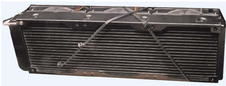
Ta chłodnica, trochę podobna do samochodowej, jest bardziej efektywna w odprowadzaniu ciepła niż prosty radiator i wentylatory. Wynika to z jej większej powierzchni aktywnej.
