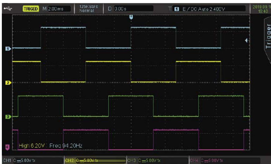
Rysunek 25. Przebiegi 2-fazowe odwrócone dla dwukierunkowego sterownika unipolarnego silnika krokowego. Zauważ, że ścieżki 3 i 4 są odwrócone lub przesunięte w fazie o 180° w stosunku do tych z rysunku 24, aby silnik obracał się w przeciwnym kierunku.
