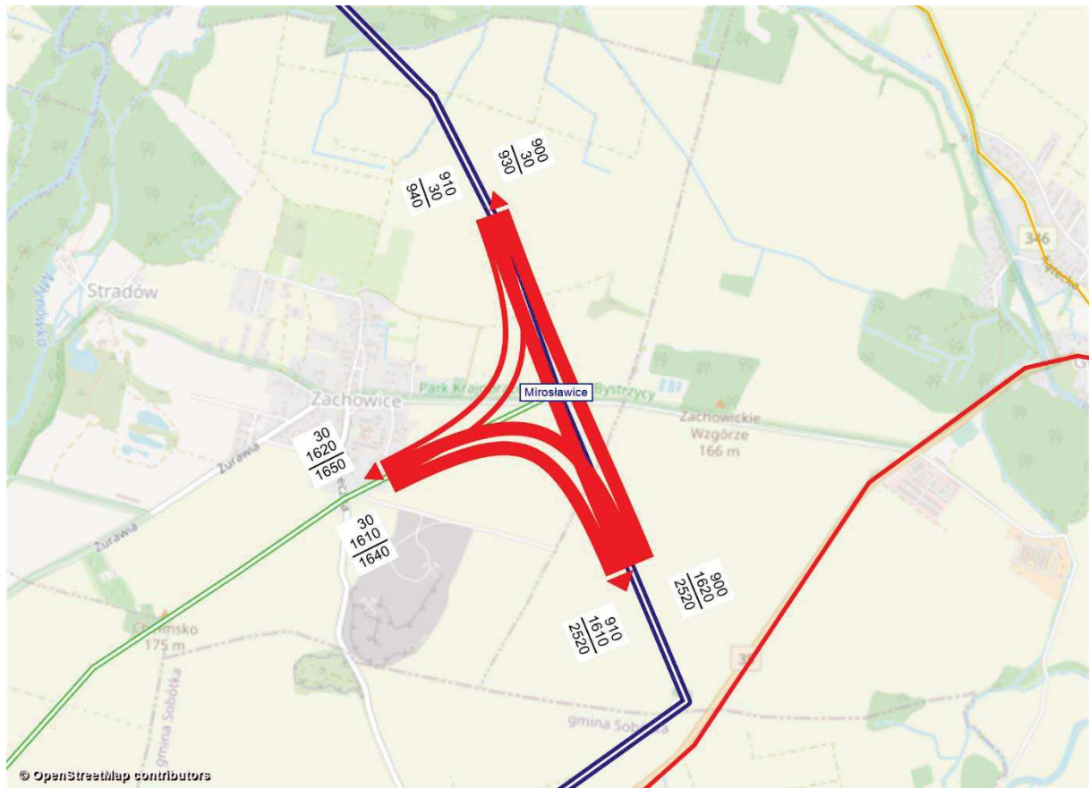
Rysunek 11.220 Kartogram ruchu pojazdów, węzeł Mirosławice, rok 2030 [poj./h], wariant W2.1W1
