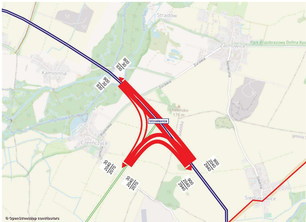
Rysunek 11.174 Kartogram ruchu pojazdów, węzeł Mirosławice, rok 2030 [poj./h], wariant W2W1
