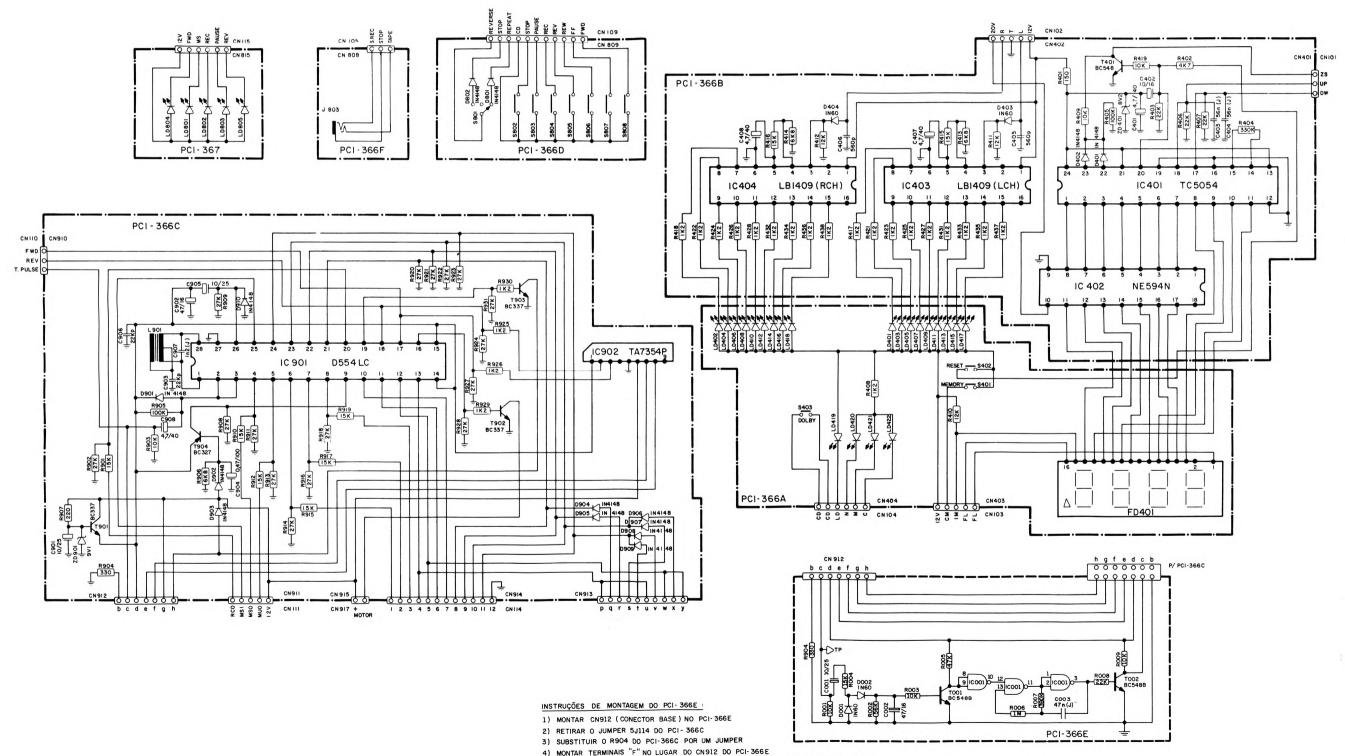
5) UNIR OS PONTOS T.Ps DOS PCI-366C E PCI-366E COM FIO #22-VD-120-10-10-RIG
