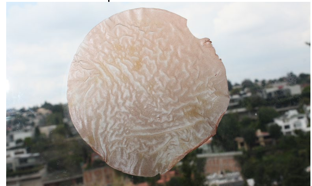
Translucidez del bioplástico con manchas
