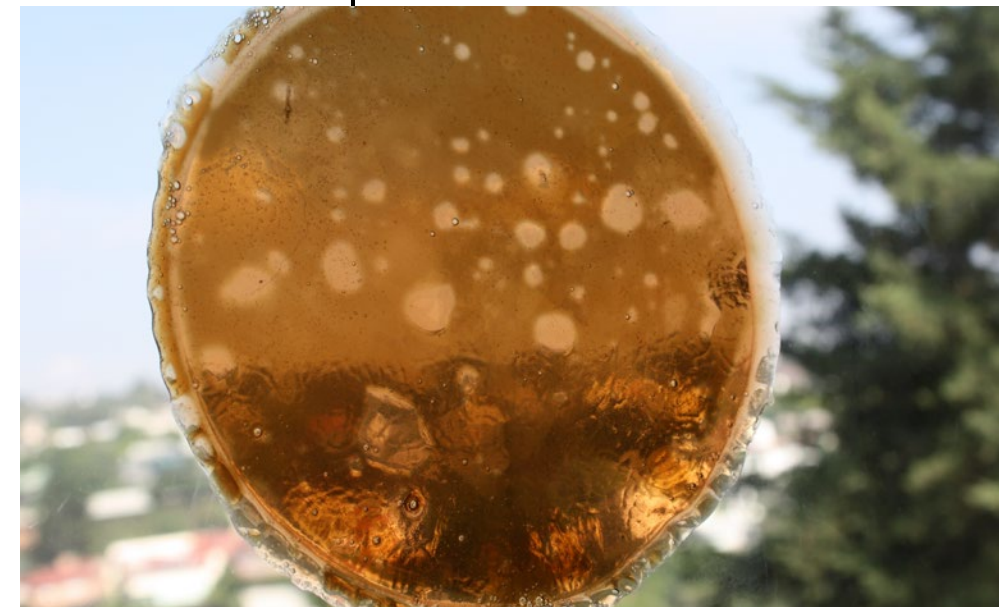
Translucidez del bioplástico con manchas
