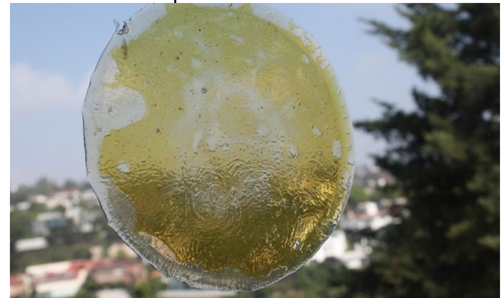
Translucidez del bioplástico con manchas
