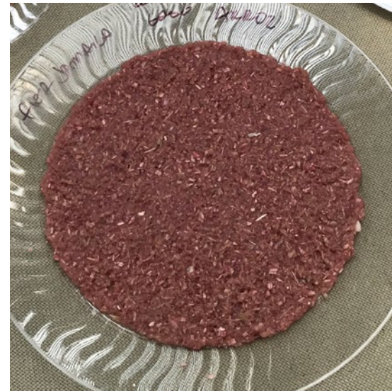
Biocompuesto recién moldeado
