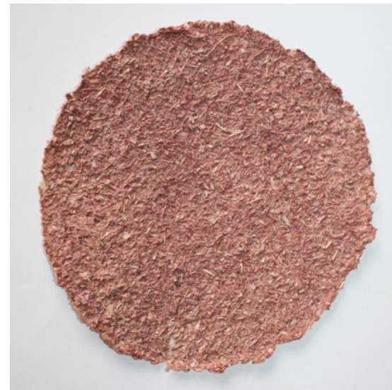
Biocompuesto seco y desmoldado
