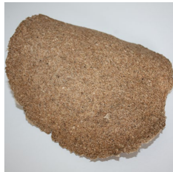
Biocompuesto seco y desmoldado
