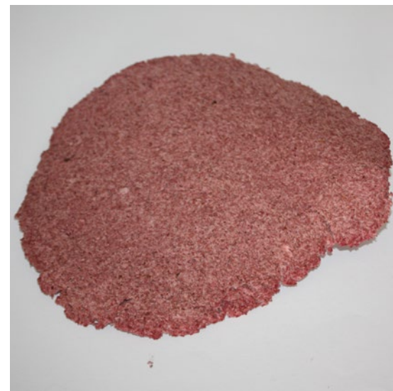
Biocompuesto seco y desmoldado
