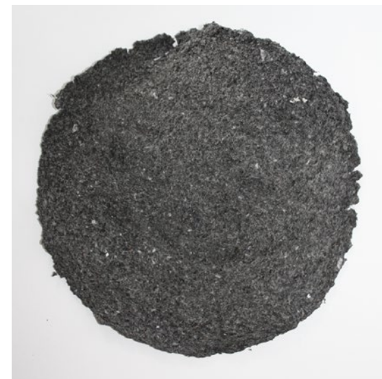
Biocompuesto seco y desmoldado
