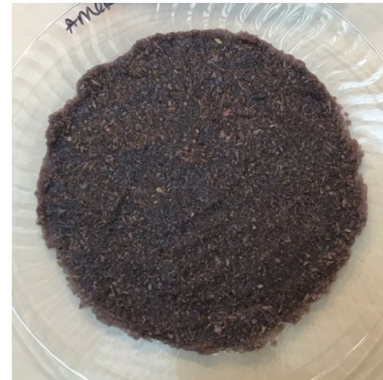
Biocompuesto recién moldeado
