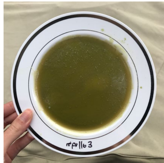
Bioplástico después de un día de secado
