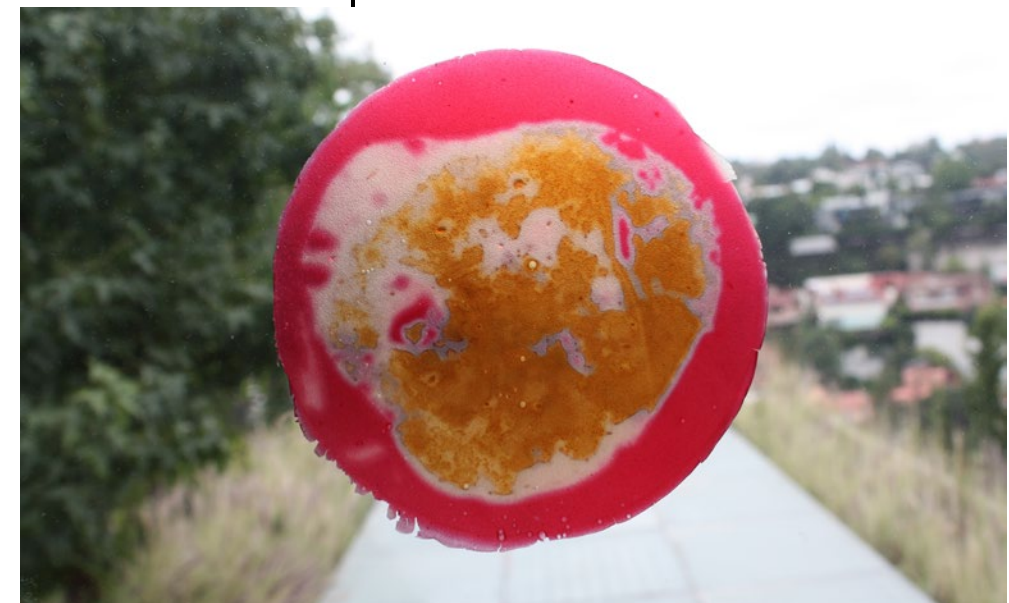
Translucidez del bioplástico con manchas
