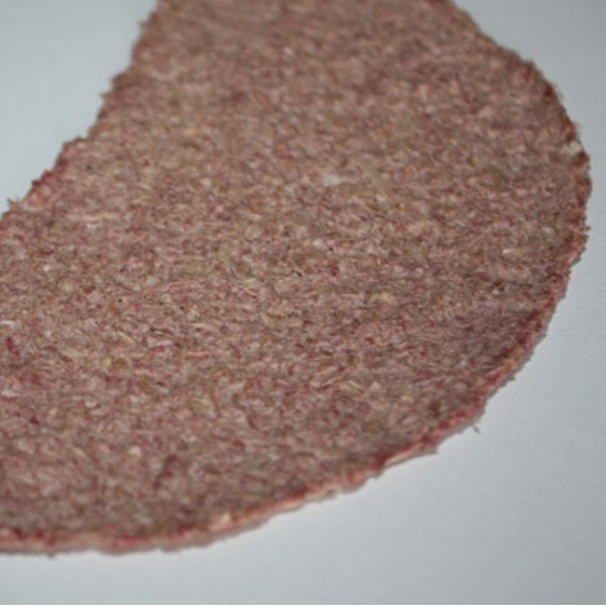
Biocompuesto de molde plano seco
