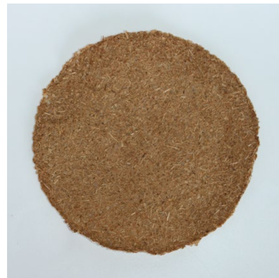
Biocompuesto seco y desmoldado
