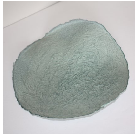
Biocompuesto seco y desmoldado
