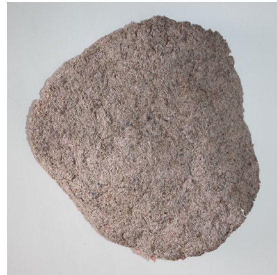
Biocompuesto seco y desmoldado
