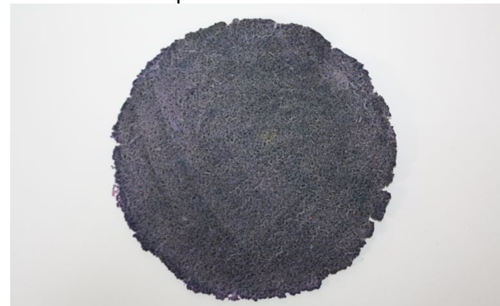
Biocompuesto seco y desmoldado
