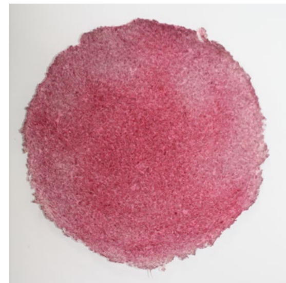
Biocompuesto seco y desmoldado
