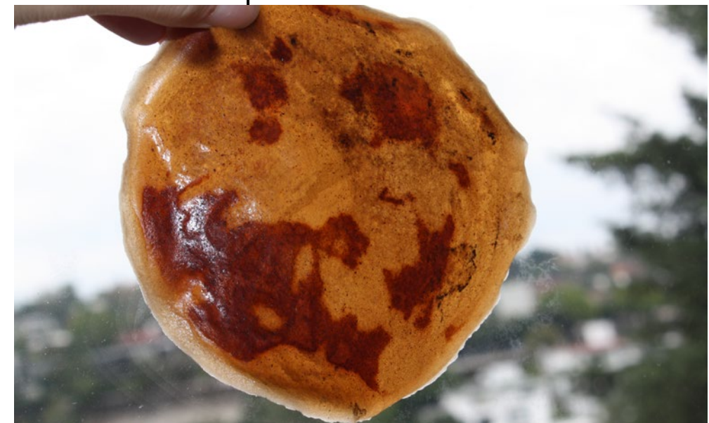
Translucidez del bioplástico con manchas
