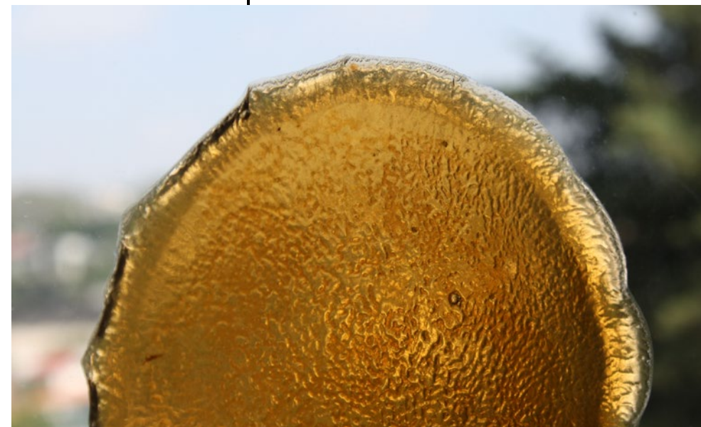
Translucidez del bioplástico con manchas
