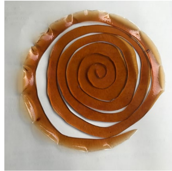
Corte del material para generar hilos
