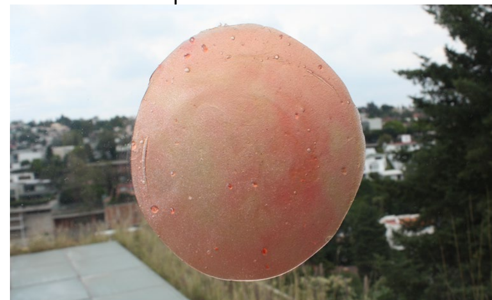
Translucidez del bioplástico con manchas
