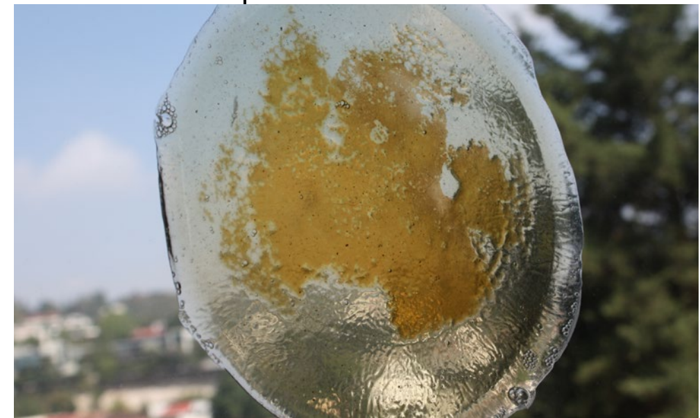
Translucidez del bioplástico con manchas
