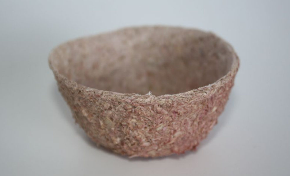
Biocompuesto de molde tridimensional seco
