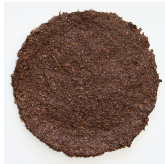
Bioplástico seco y desmoldado
