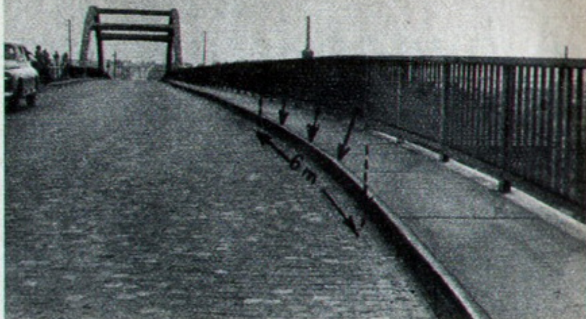
Az autóbusz jobb oldali első kerekétől eredő, a járdaszegélyen látható 6 m hosszúságú gumihorzsolási nyom
