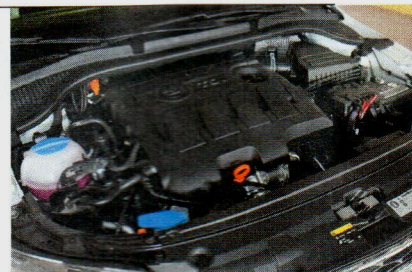
250 Nm-es nyomatékot produkál a közös nyomócsöves dízelmotor
