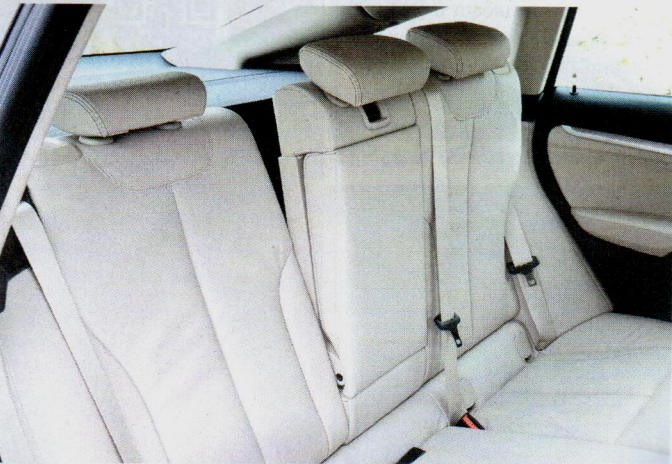
15 különböző pozícióban rögzíthető a hátsó üléstámla
