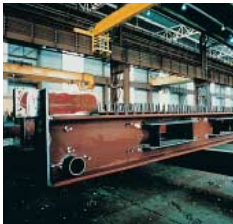
Poutre avec ouverture dans l'âme
