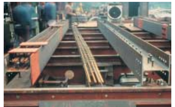
Parachèvement de poteaux mixtes avec des connecteurs supplémentaires dans les zones de transfert
