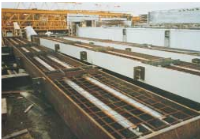
Poteaux mixtes avec renforts soudés sur l'âme
