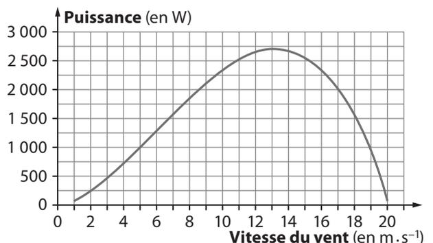
La puissance développée par l'éolienne semble maximale pour un vent de  $13 \text{ m} \cdot \text{s}^{-1}$  environ.
