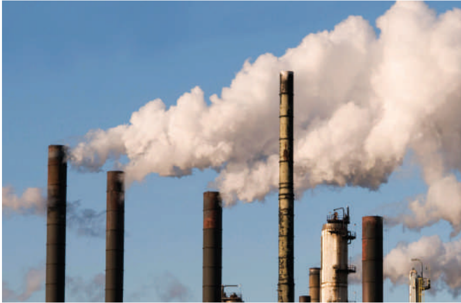
■ الشكل 14-2 الرماد المتصاعد من المداخن نتيجة ثانوية لاحتراق الفحم. ويمكن استعمال مرشحات الترسيب الكهروستاتيكي لتقليل هذا الرماد.
