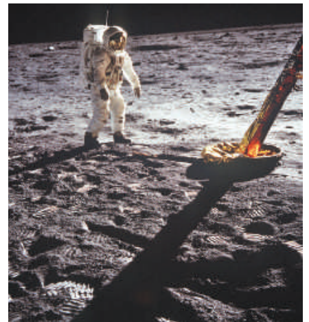
الشكل 1-2 إن رائد الفضاء ومركبته يولدان ضغطاً على سطح القمر. إذا كانت كتلة المركبة 7300 \text{ kg} تقريباً، وتستقر على أربعة أقدام قطر كل منها 91 \text{ cm} ، فما مقدار الضغط الذي تؤثر به على سطح القمر؟ وكيف تستطيع أن تقدر الضغط الذي يؤثر به رائد الفضاء.
