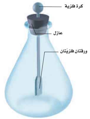
■ الشكل 8-2 الكشاف الكهربائي؛ جهاز يستخدم للكشف عن الشحنات الكهربائية. في الكشاف الكهربائي المتعادل تكون الورقتان معلقتين رأسياً بحرية، وتلامس إحداهما الأخرى.
