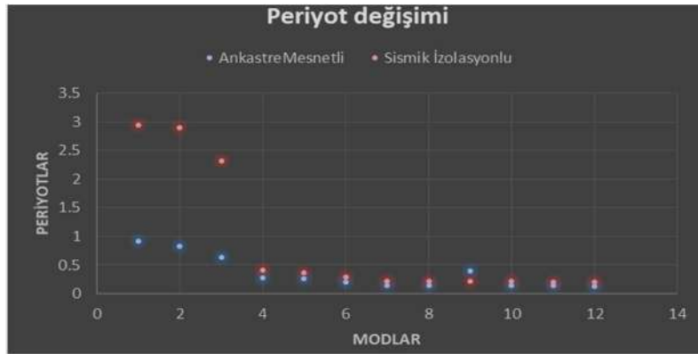
Şekil 6:Zemine ankastre ve sismik yalıtımlı yapının periyot değerlerinin karşılaştırılması
