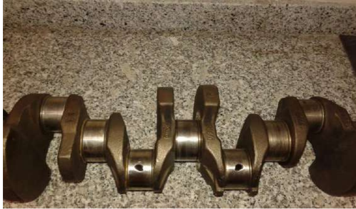
Şekil 1: Krank mili yataklarındaki aşınma izleri
