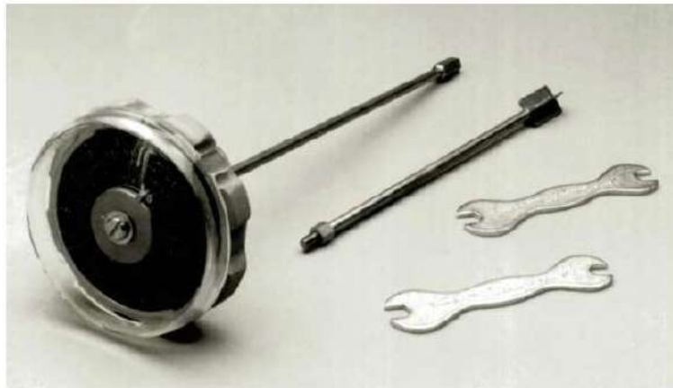
Şekil 2. Laboratuvar Vane deney ekipmanı (Das, 2018)
