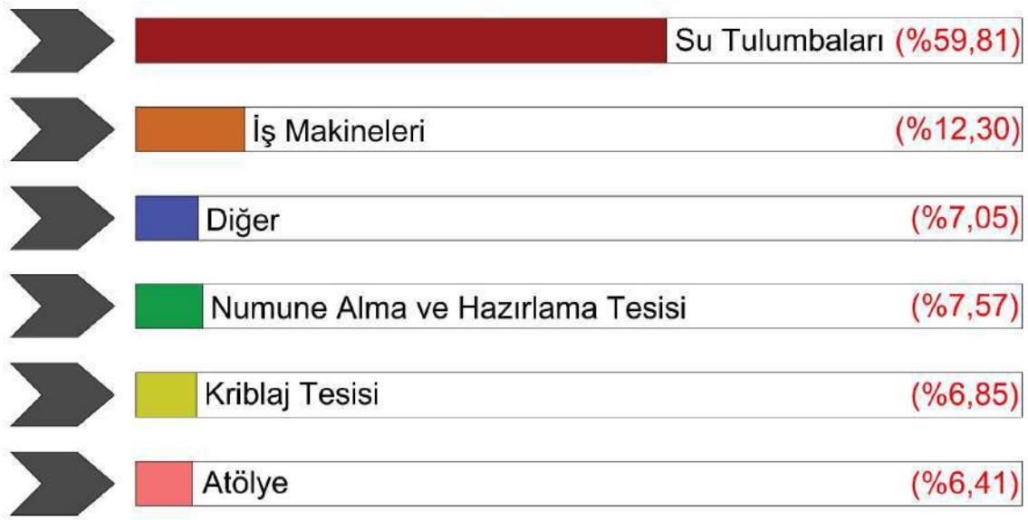
Şekil 3. ÇLİ elektrik enerjisi tüketiminin dağılımı (Distribution of electrical energy consumption in CLI).
