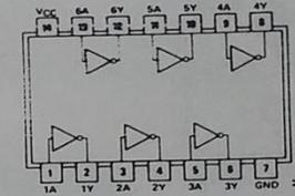
Figure 2-1 Implantation de l'inversion par le CI 7404 comprenant six inverseurs.
