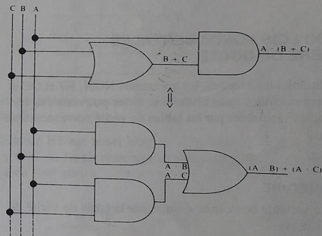
Il est important de noter que le deuxième circuit exige trois portes au lieu de deux pour le premier. Il n'est donc pas indifférent de réaliser les circuits d'une façon ou d'une autre. Pour minimiser les coûts, il peut être utile de minimiser le nombre de portes.
