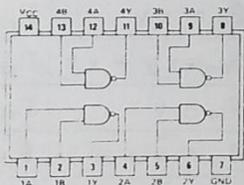
Figure 2-6 Implantation de la fonction NON-ET par le CI 7400 comprenant quatre portes NON-ET à deux entrées.
