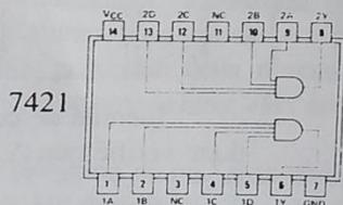
Figure 2-4 Portes ET à trois entrées (7411) et à quatre entrées (7421)
