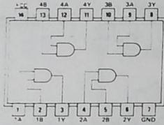
Figure 2-2 Implantation de la fonction ET par le CI 7408 comprenant quatre portes ET à deux entrées.
