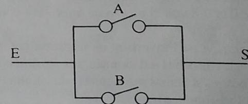
Si on a une tension en E, on aura une tension en S si A ou B est fermé ou si les deux le sont. Ce cas sera représenté par l'équation:
