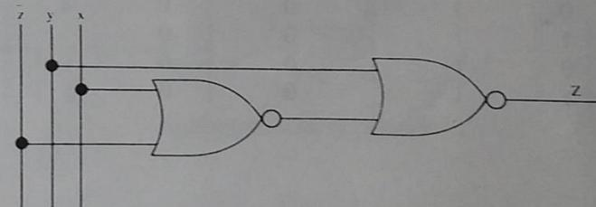
Nous voyons donc qu'en manipulant algébriquement une fonction on peut choisir le type de portes de son implantation. Dans notre cas, l'implantation NON-OU est la plus simple puisqu'elle ne nécessite qu'un seul type de porte (donc un seul type de circuit intégré) et seulement deux portes (donc un seul circuit intégré). C'est un exemple de l'utilité pratique des théorèmes de De Morgan.
