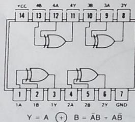
**Figure 2-7** Implantation de la fonction OU exclusif par le CI 7486 comportant quatre portes OU exclusif à deux entrées.
