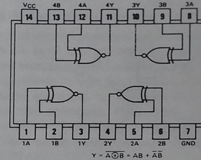
**Figure 2-8** Implantation de la fonction égalité par le CI 74266 comportant quatre portes NON-OU exclusif à deux entrées.
