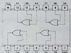
Figure 2-5 Implantation de la fonction NON-OU par le CI 7402 comprenant quatre portes NON-OU à deux entrées.
