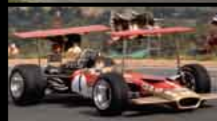
Az 1969-es szezon elején a Lotus pilótái manuálisan tudták állítani első és hátsó légtelítőket
