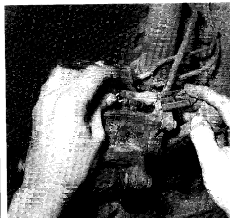
Desconexión del testigo de desgaste.
