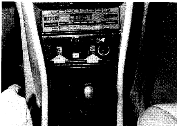
Tornillos situados bajo el cenicero.
