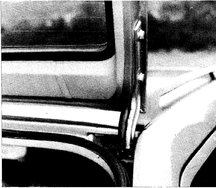
Tornillos de fijación del portón (break).
