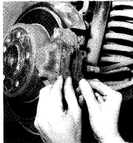
Desmontaje de las pastillas de freno traseras.
