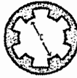
مقطع ماسورة سلاح حربي يظهر شكل الميازيب
