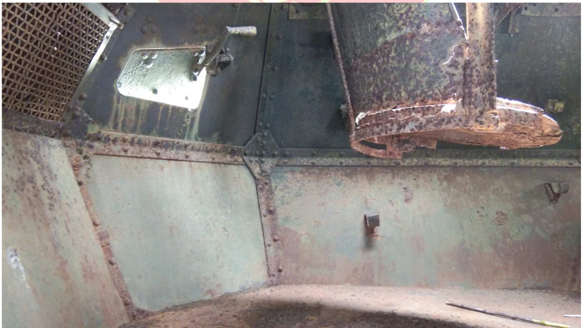
ပုံ၏ဘယ်ဘက်တွင် ချောင်းကြည့်ပေါက် (port hole) နှင့် လက်ကိုင်ကိရိယာဖြင့် ညာဖက်တွင် သံချပ်ကာယာဉ်အပေါ်မှ အကဲကြည့်ပေါက် (observer hatch) တွင်တပ်ဆင်ထားသော ထိုင်ခုံကိရိယာတွေ့ရသည်။
