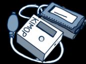
Colocar la mangua alrededor de la parte superior del brazo. Presionar el botón de encendido e inflar bombeando manualmente hasta 30mmHg por encima de su presión sistólica prevista y retirar. Aparecen las lecturas de presión sistólica y diastólica en la pantalla.
