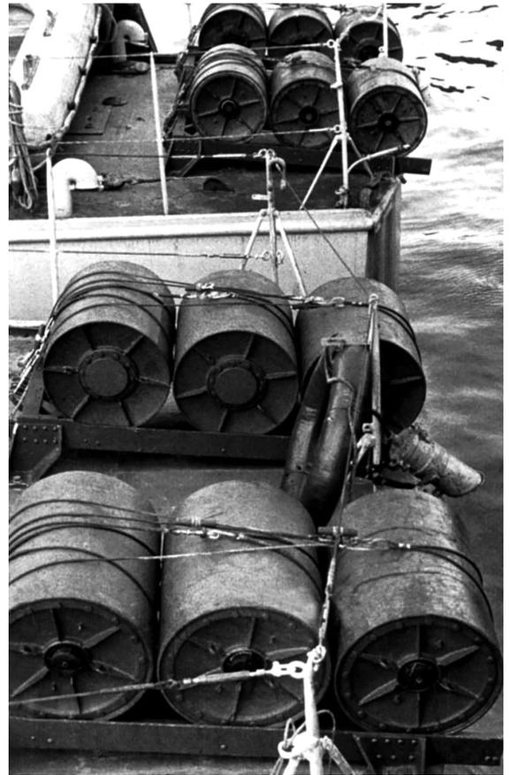
▲ Sur ces plages arrière de *S-Boote* ont été installées deux rampes de largage pour trois grenades ASM *Typ WBG*. La molette sur le côté des charges permet de régler le retardateur.
