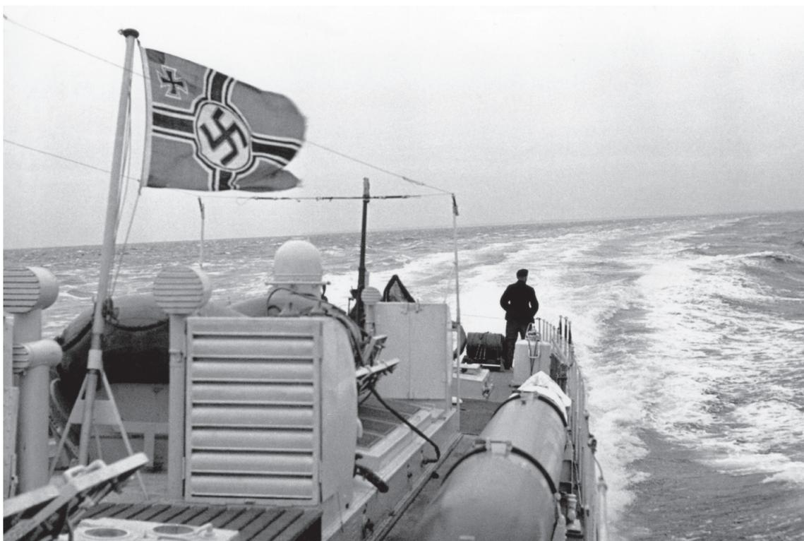
◀ En dépit de la présence de nombreux aérateurs, du mâtereau, des mâts radio, des torpilles de réserve et de diverses écoutilles, la plage arrière des *S-Boote* se couvrira d'armes au fur-et-à-mesure des années de guerre.
