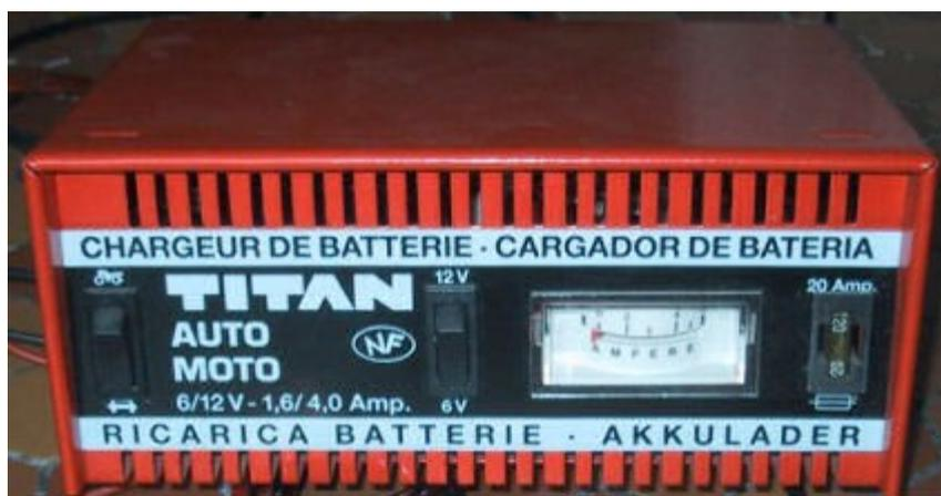
Ce type de chargeur simple de conception est en voie de disparition. Le « problème » de ce type de chargeur c'est qu'il n'y a aucun contrôle de la tension de la batterie en cours de charge et si on le laisse plus longtemps que prévu, celle-ci peut dépasser la valeur maximale recommandée, ce qui peut conduire à dégrader la batterie (ébullition de l'électrolyte), soit l'effet inverse de celui recherché.
