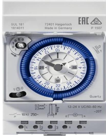
**كما هو موضح بالصورة** ان الريش التي تم تنزيلها هي التي يعمل عندها التايمر اي يعمل من الساعة 5.30 صباحا ويفصل عن الساعة 9.30 صباحا ويعمل ثانيا عند الساعة 17(5 مساء) ويفصل عند الساعة 21 (9 مساء) وذلك عند ضبط التايمر على **0**
