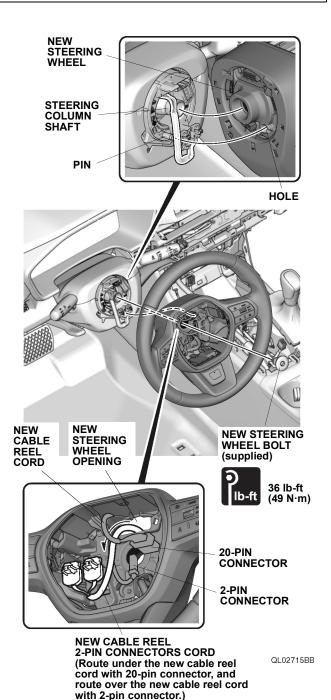
79. Install the new steering wheel bolt.
