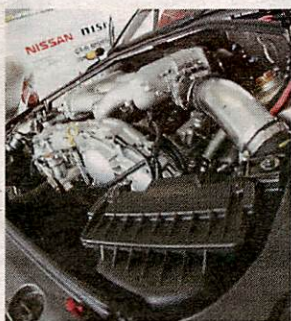
Exot auch unter der Haube: Der 3,8-l-V6-Biturbo leistet 550 PS und stemmt 630 Nm Drehmoment auf die Hinterachse
