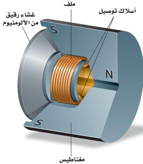
■ الشكل 4-1 يبين الرسم حركة ملف الميكروفون؛ حيث يتصل غشاء رقيق من الألومنيوم بملف موضوع داخل مجال مغناطيسي. وعندما يهتز الغشاء بفعل موجات الصوت يتحرك الملف في المجال المغناطيسي مولدًا تيارًا كهربائيًا يتناسب مع موجات الصوت.
