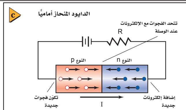
وتنتج هذه الشحنات قوى في الاتجاه المعاكس، مما يؤدي إلى توقف حركة المزيد من ناقلات الشحنة. وتترك المنطقة المحيطة بالطبقة الفاصلة دون فجوات أو إلكترونات حرة، فتتضرب فيها ناقلات الشحنة، لذلك تسمى **طبقة النضوب**. ولأن طبقة النضوب لا تحتوي على ناقلات الشحنة، فإنها تعدّ رديئة التوصيل للكهرباء ولذلك، يتكون الدايمود من موصلين جيدي التوصيل نسبياً عند الطرفين بينهما منطقة رديئة التوصيل.
