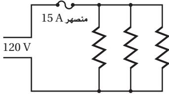
■ الشكل 10-5 يسمح توصيل التوازي في المنزل بتزامن توصيل أكثر من جهاز؛ أي استعمال أكثر من جهاز في الوقت نفسه. وإذا استعمل عدد كبير من الأجهزة في الوقت نفسه فقد يؤدي ذلك إلى انصهار المنصهر الكهربائي.
