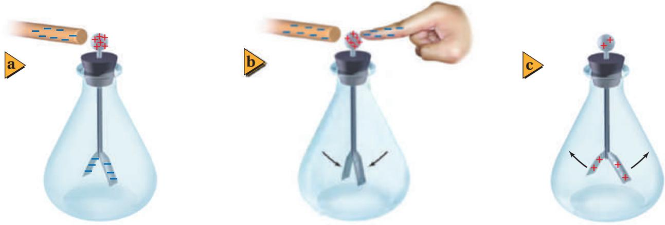
■ الشكل 11-2 يحد قضييب سالب الشحنة على فصل الشحنات على الكشّاف الكهربائي (a). يتم تأريض الكشّاف الكهربائي عن طريق لمسه، فتنتقل الإلكترونات السالبة من الكشّاف الكهربائي إلى الأرض (b). يُفصل تأريض الكشّاف قبل إبعاد القضييب، فيصبح الكشّاف الكهربائي موجب الشحنة (c).
