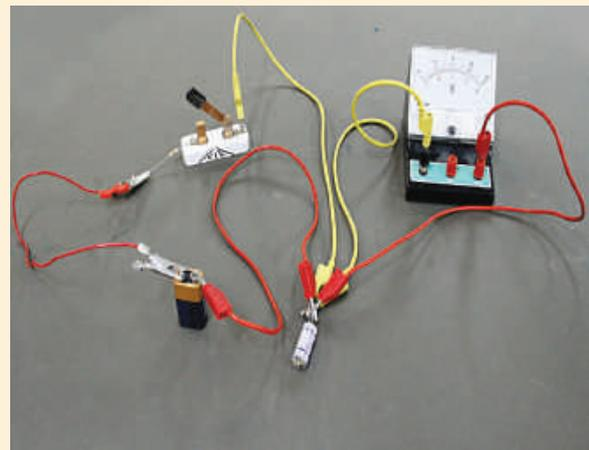
البطارية معاً. ركب الدائرة كما هو موضّح في الصورة، وذلك بتوصيل أحد طرفي المقاومة بطرف المفتاح الكهربائي، حيث تستخدم المقاومة لتقليل شحن المكثف إلى معدل يكون فيه قابلاً للقياس، ثم صل الطرف الآخر للمقاومة مع القطب السالب للبطارية 9V. ثم تفحص المكثف 1000 μF؛ لتحديد أيّ طرفيه قد علّم بإشارة سالبة، أو سَهْم مع إشارة سالبة عليه، حيث يُشير ذلك إلى الطرف الذي سيوصل مع القطب السالب للبطارية، ثم صل هذا القطب بالطرف الآخر للمفتاح الكهربائي. وصل الطرف الموجب للمكثف مع الطرف الموجب للبطارية.
