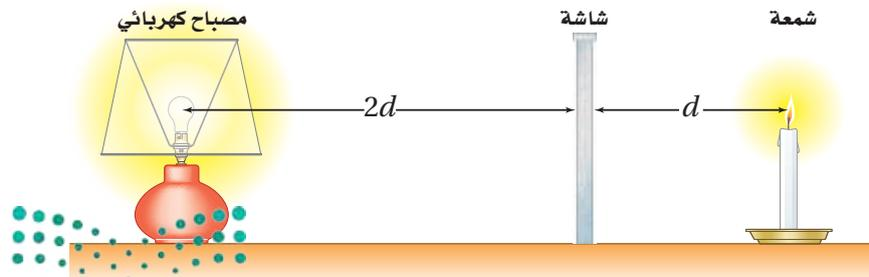
■ الشكل 4-6 الاستضاءة متساوية على جانبي الشاشة، مع أن المصباح الكهربائي أكثر سطوعاً من الشمعة.
