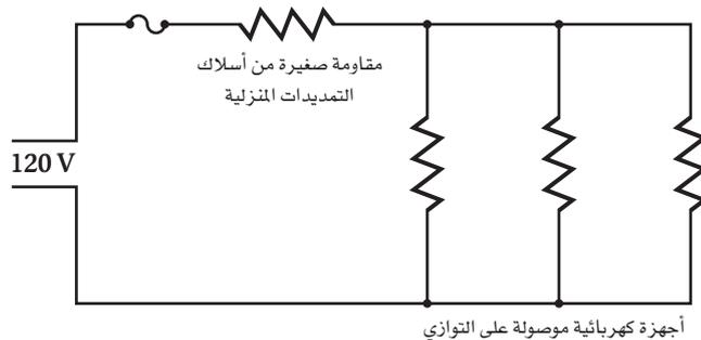
■ الشكل 11-5 تتصل المقاومة الصغيرة لأسلاك التمديدات الكهربائية على التوالي بالأجهزة الكهربائية الموصولة على التوازي في التوصيلات المنزلية.
