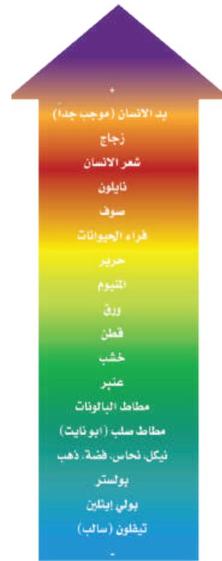
■ الشكل 2-3 ترتب سلسلة الدلك الكهربائي قائمة المواد من حيث الأكثر فقداً للإلكترونات عند أعلى السهم إلى الأكثر اكتساباً للإلكترونات في ذيل السهم.
