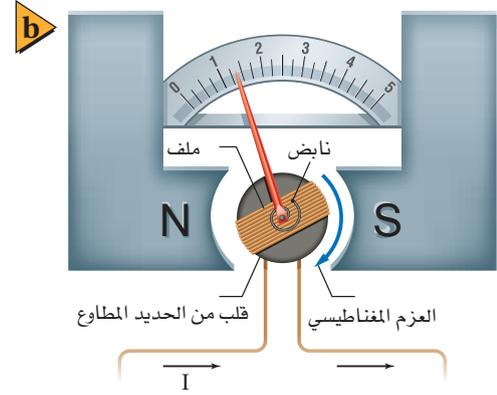
■ الشكل 19-6 إذا وضعت حلقة سلكية يمر فيها تيار في مجال مغناطيسي فسوف تدور (a). يدور ملف الجلفانومتر بالتناسب مع مقدار التيار (b).
