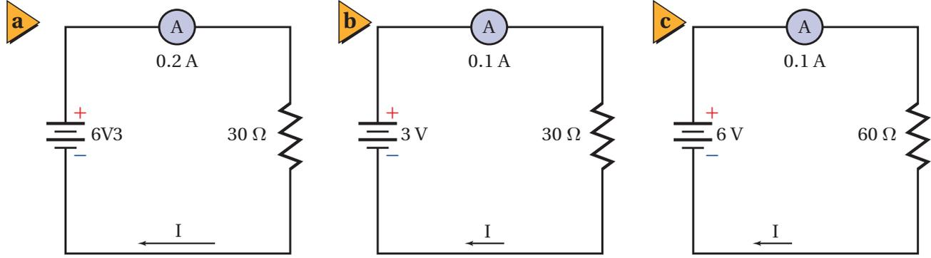
■ الشكل 3-4 يمكن التحكم في التيار المار في الدائرة البسيطة الموضحة في الشكل (a) عن طريق إزالة بعض الخلايا الجافة (b) أو بزيادة مقاومة الدائرة (c).
