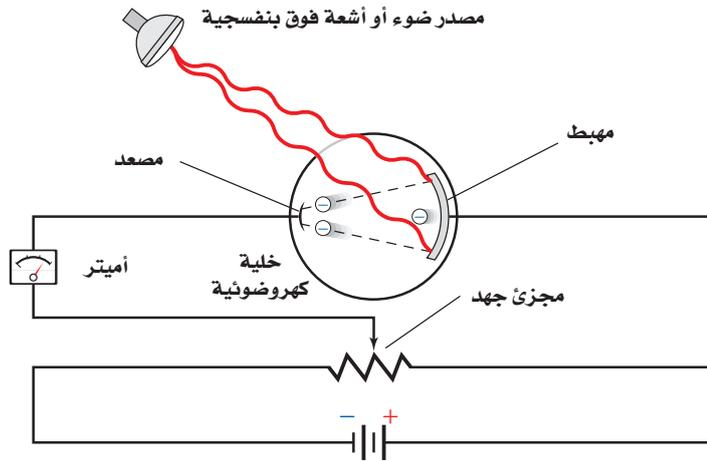
■ الشكل 3-3 يمكن قياس الطاقة الحركية العظمى للإلكترونات المتحررة من المهبط باستخدام هذا الجهاز: حيث يقيس الأميتر التيار المار في الدائرة. ويتعدّل مجزئ الجهد يمكن للشخص الذي يجري التجربة تحديد فرق الجهد الذي يصبح عنده التيار المار في الدائرة صفرًا. عندها يمكن قياس الطاقة الحركية العظمى الممكنة للإلكترونات المتحررة.
