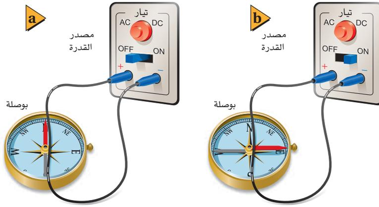
■ الشكل 6-8 باستخدام أدوات مماثلة لتلك الموضحة في الشكل (a) تمكن أورشند من توضيح العلاقة بين الكهرباء والمغناطيسية، وذلك بتمرير تيار كهربائي في السلك (b).
