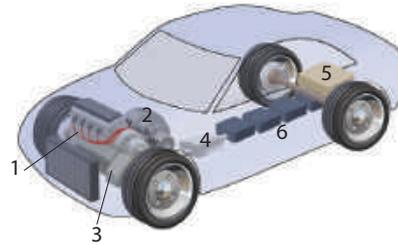
**كيف تعمل السيارات المهجنة؟** يبين الرسم التوضيحي أعلاه أحد أنواع السيارات المهجنة، الذي يسمى التهجين المتوازي. حيث يُشغّل محرك الاحتراق الداخلي الصغير (1) السيارة خلال معظم أوضاع القيادة. ويتصل محرك الوقود والمحرك الكهربائي مع العجلات (3) على جهاز ناقل الحركة نفسه. وتعمل الأدوات الإلكترونية المبرمجة (4) على تحديد وقت استعمال محرك الكهرباء، ووقت استعمال محرك الوقود، ووقت استعمالهما معًا.
