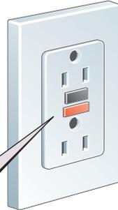
**4** يُوصّل زر الفحص في دائرة قاطع التفريغ الأرضي الخاطئ مقاومة صغيرة بالدائرة الكهربائية، فينشئ مرة أخرى تيارات غير متساوية في المحوّل، ويفتح الدائرة الكهربائية.
