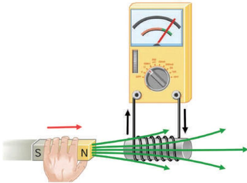
■ الشكل 11-1 يؤدي اقتراب القطب الشمالي للمغناطيس من الملف إلى مرور تيار حثي في الملف. ويمكن توقع اتجاه هذا التيار المتولد بواسطة قانون لنز.
