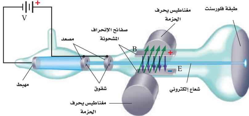
■ الشكل 1-2 قيست نسبة شحنة الإلكترون إلى كتلته أولاً باستخدام تعديلات تومسون على أنبوب الأشعة المهبطية. وقد استخدم كلاً من المغناط الكهربائية وصفايح الانحراف المشحونة للتحكم في مسار حزمة الإلكترونات.
