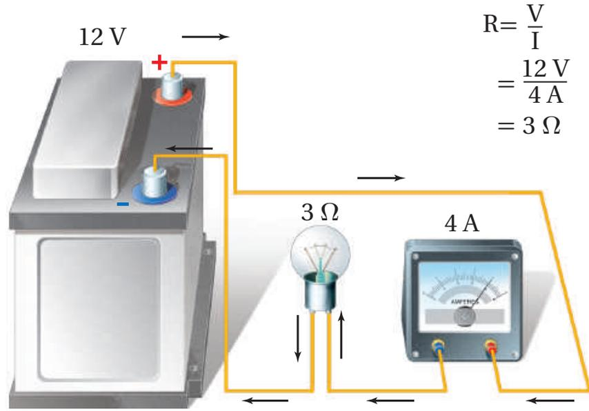
يمر فيه تيار شدته 1 A عندما يكون فرق الجهد بين طرفيه 1 V. ويوضح الشكل 2-4 دائرة كهربائية بسيطة تربط بين المقاومة والتيار والجهد. وقد أكملت الدائرة الكهربائية بتوصيل أميتر بها؛ وهو جهاز يقيس شدة التيار الكهربائي.
