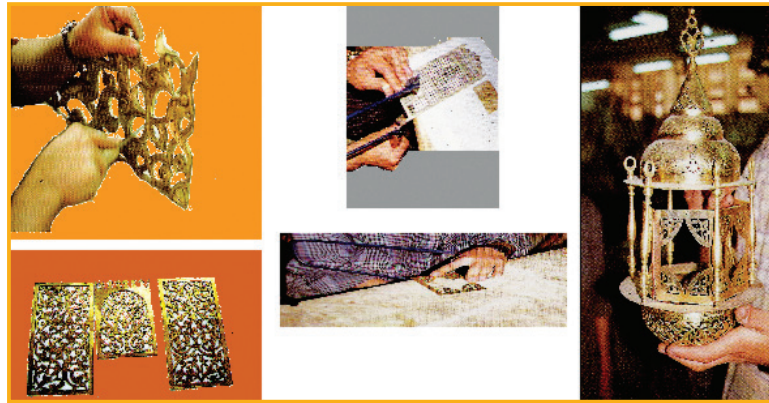
الشكل (٨). طرق استخدام أزاميل ومنشار المعادن
