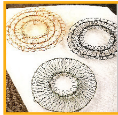
الشكل (٤٠): أسلاك رفيعة للربط
