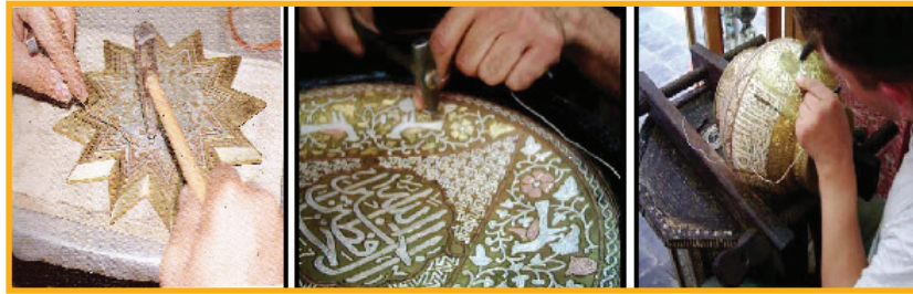
الشكل (٣٥): طريقة التكفيت
