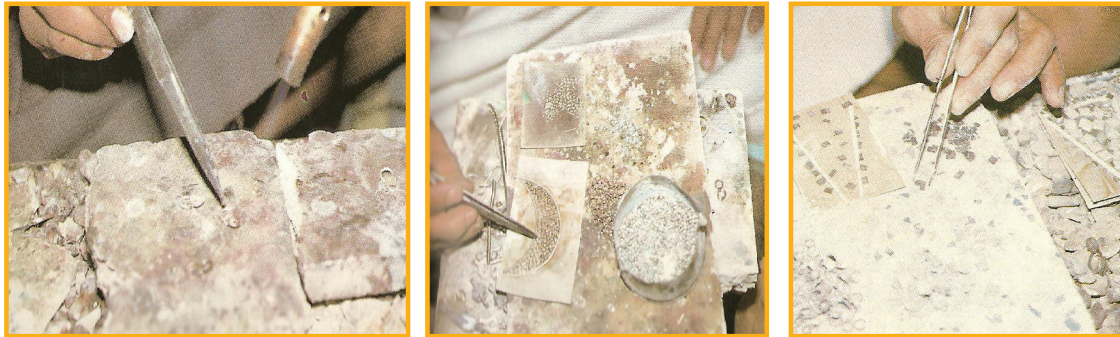
الشكل (٥٧): عملية اللحام وتثبيت العناصر
