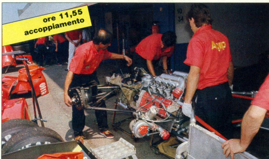
A sinistra, la fase di accoppiamento tra cambio e il nuovo motore. A destra, uno dei momenti più delicati della sostituzione: tutti e quattro i meccanici addetti alla vettura sono impegnati a montare il propulsore. Il numero degli attacchi da effettuare è elevato. Il tutto è reso difficoltoso anche dall'albero di trasmissione che va inserito all'interno della frizione (FotoStefanini)
