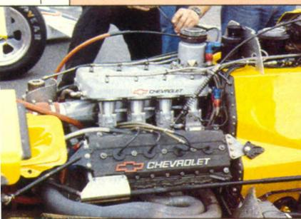
Sopra, il motore Chevrolet a otto cilindri a V di 90° montato sulla Penske Pc 15. Sotto, la nuova sospensione anteriore (FotoCevenini)
