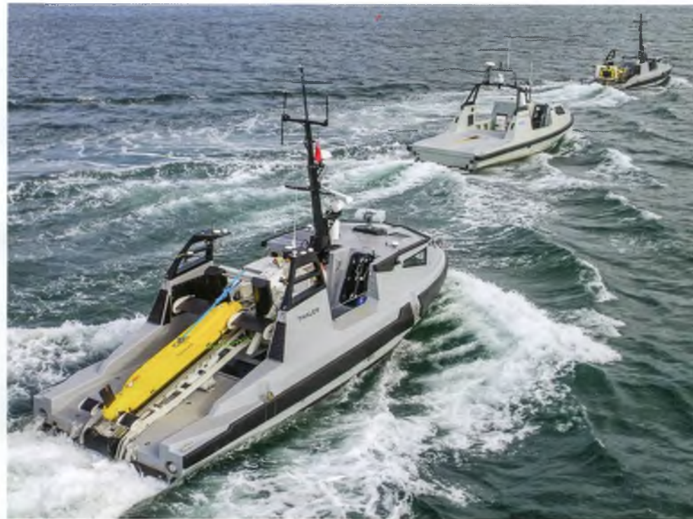
▲ Brytyjski przykład użycia nawodnych jednostek autonomicznych jako nosicieli uzbrojenia MCM. Koncepcja ARCIMS (w ramach projektu Wilton konsorcjum SV/L3Harris i Thales) jest oczywiście nowoczesna choć np. Deutsche Marine (wówczas jeszcze Bundesmarine ) wprowadziła system Trojka już w latach 80. XX wieku.
