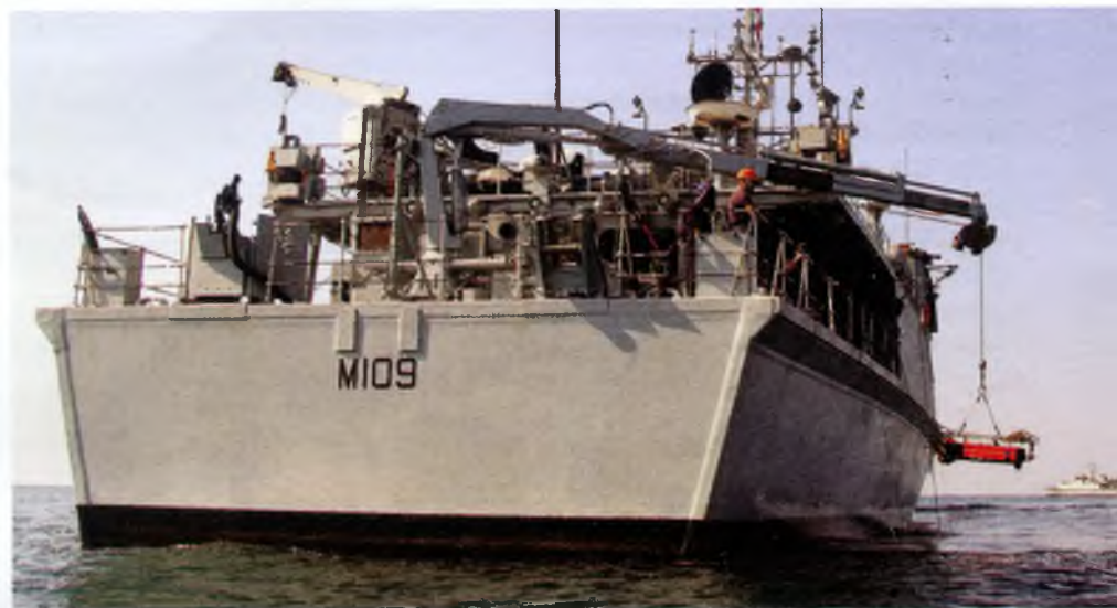
▲ Opuszczanie pojazdu podwodnego systemu SeaFox z brytyjskiego niszczyciela min HMS Bangor (M109) typu Sandown .
