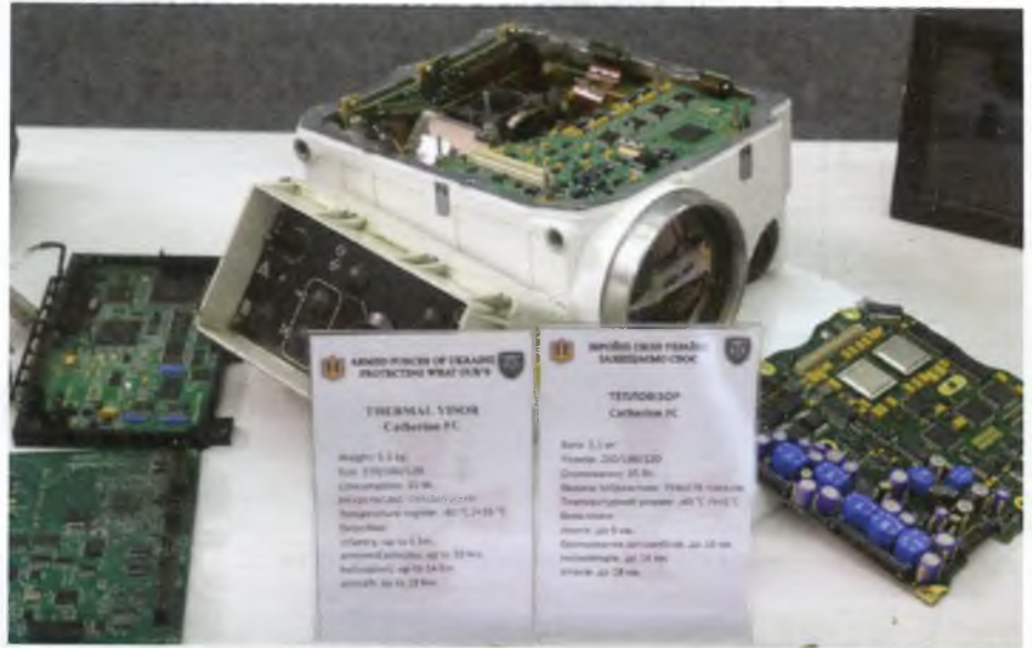
▲ Ukraińska prezentacja osprzętu wyjętego z rosyjskich T-90 – francuska kamera termowizyjna Catherine-FC .
