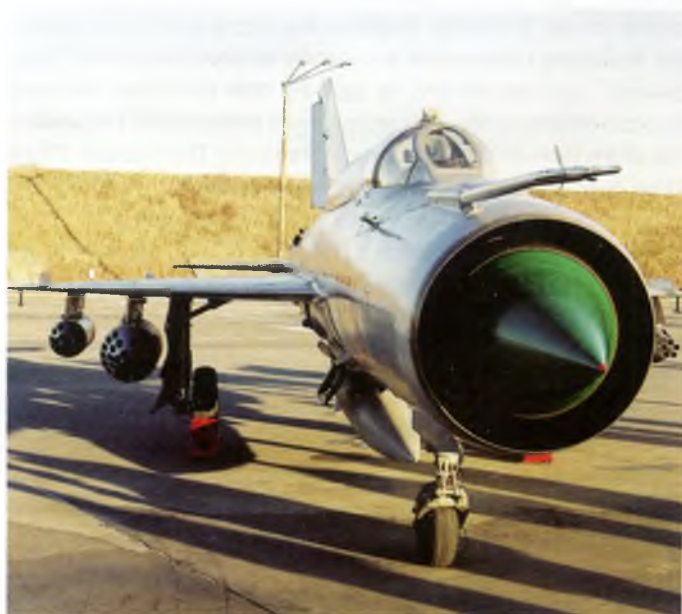
▲ Samoloty MiG-21 można było wykorzystywać także do zadań uderzeniowych na cele lądowe i morskie. Na zdjęciu MiG-21MF z podwieszonymi wyrzutniami UB-16 i UB-32 dla niekierowanych pocisków raketowych S-5 kal. 57 mm
