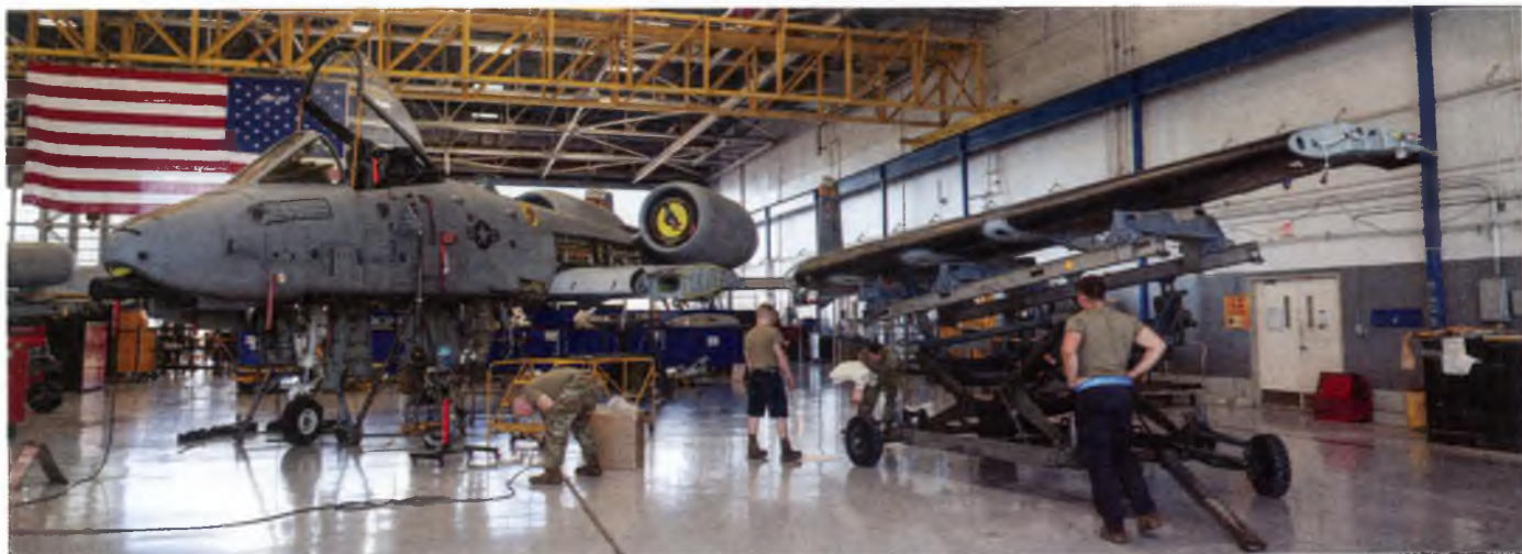
▲ Kwestia sprawności technicznej Thunderbolt II stanowi istotny element w dyskusji nad możliwościami ich dalszej służby. Wymiana skrzydeł w teorii pozwala na eksploatację maszyn tego typu do 2035 roku.
