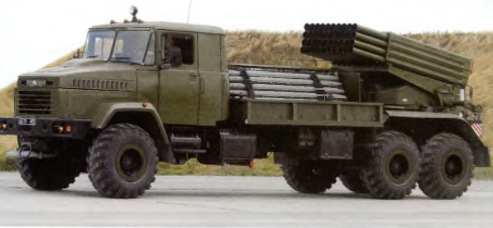
▲ Bastion-2 , czyli Grad z dodatkową jednostką ognia do szybkiego przeładowania.
