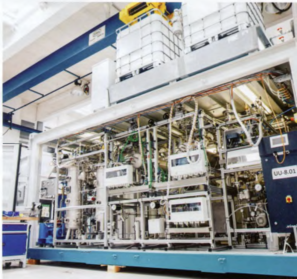
▲ W procesie LOHC organiczny płynny nośnik pochłania wodór i uwalnia go tylko wtedy, gdy jest to potrzebne. Wodór pozostaje więc związany chemicznie i nie może uciec w postaci gazowej. W rezultacie da go się bezpiecznie przygotować i przechowywać oraz niedrogo przewozić.
