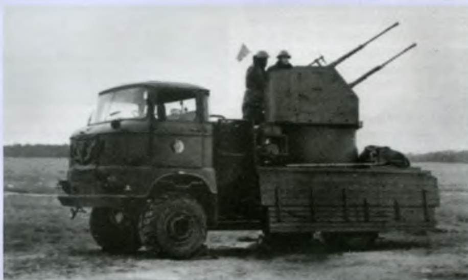
► Wieżyczka 2M-3M zamontowana na ciężarówce IFA W50L należącej do Volksmarine (NRD).
