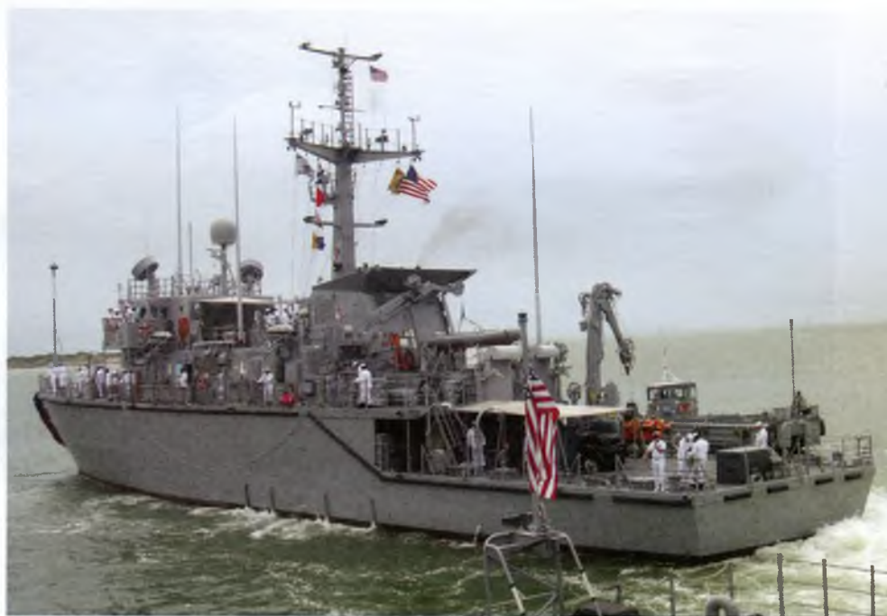
▲ Amerykanie cierpią na chroniczny brak wyspecjalizowanych jednostek MCM. Na zdjęciu wywodzący się z nieśmiertelnego włoskiego typu Lerici/Gaeta reprezentant typu Osprey – USS Black Hawk (MHC-58), jeszcze pod banderą USA (obecnie wszystkie te jednostki sprzedano lub wycofano ze służby).
