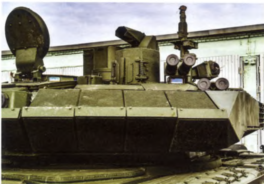
◀ Zbliżenie na wieżę z blokami pancerza Relikt oraz przyrządy obserwacyjno-celownicze działonowego (na pierwszym planie) i dowódcy – elementów SKO Kalina .
