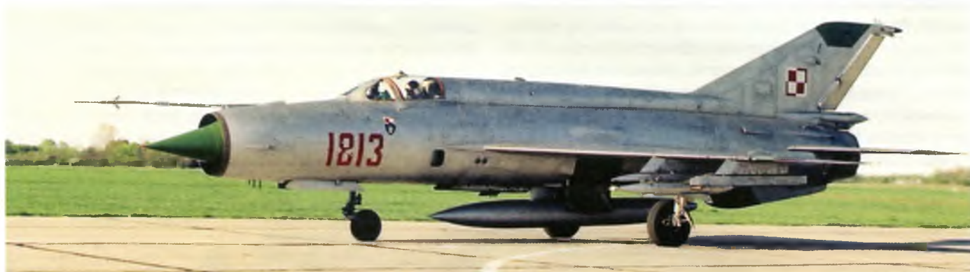
▲ Samoloty MiG-21M były pierwszymi z tej rodziny posiadającymi stałe działko i cztery belki podskrzydłowe do podwieszania uzbrojenia.
