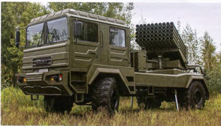
▲ 50 prowadnic pod pociski rakietowe kal. 122 mm, czyli wyróżniająca się nie tylko zmienionym podwoziem (w tym przypadku KrAZ-5401NE) wyrzutnia BM-21UM Berest .
