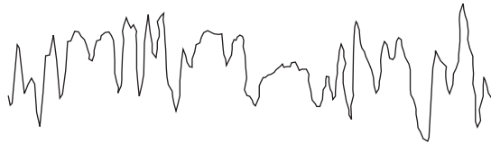
Figure 6-18 Actual 1000BASE-T Signal
