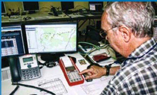
Desde este hangar se controlan todos los coches del WRC. Arriba: Juan Petisco hace una comprobación en el 'chronoprinter', un dispositivo que es idéntico al que los jueces tienen en la salida, llegada y cada punto de control de un rally y que guarda los datos que los ingenieros pueden ver en pantallas como la de abajo, con los coches del Rally de Cataluña 2013
