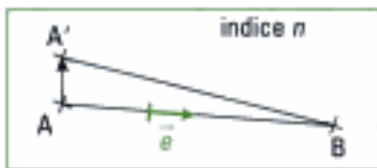
Fig. 21 – Différentielle du chemin optique : \overline{AA'} est un déplacement élémentaire qui produit une petite variation de chemin optique entre A et B.
