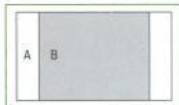
Fig. 15.b – Polaroïds décroisés (cas de filtres dichroïques). À leur intersection, la lumière passe. Leurs directions de polarisation sont parallèles.
