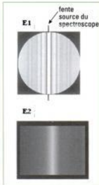
Fig. 23 – Figures d'interférences observées sur l'écran E 1 et spectre de la lumière issue de la frange centrale en lumière blanche : ce spectre est continu. La bande verticale claire correspond à la lumière jaune du spectre.
