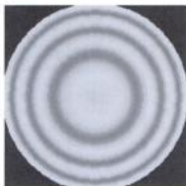
Fig. 20.a – Interférogramme et figure d'interférences pour un déplacement X_M correspondant à un maximum de contraste.
