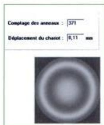
Fig. 21 – Comptage automatisé des anneaux et mesure du déplacement du chariot pour une radiation de longueur d'onde 590 nm.
