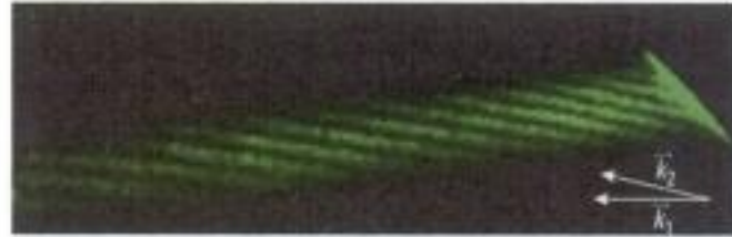
Fig. 2 – Interférences par superposition de deux ondes planes: les franges rectilignes sont les intersections de l'écran avec les deux faisceaux issus d'un même laser qui interfèrent. La ligne oblique à droite de la photographie est due au reflet du bord de l'écran.
