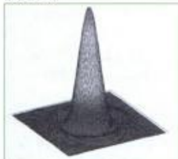
Fig. 17.b – Figure de diffraction donnée par une ouverture circulaire : élévation montrant l'évolution du niveau de l'intensité lumineuse.
