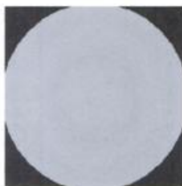
Fig. 20.b – Interférogramme et figure d'interférences pour un déplacement X_M correspondant à un minimum de contraste : anticoincidence.
