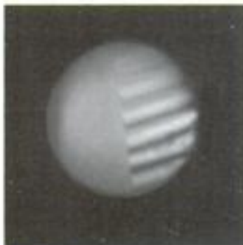
Fig. 26 – Détermination de l'indice d'une lame de verre en lumière blanche : observation de la figure obtenue sur l'écran.
