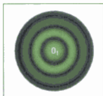
Fig. 21 – Figure de diffraction d'un trou circulaire : tache d'Airy.
