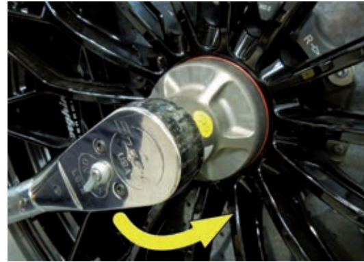
Fig. 172 Loosening the single bolt.
