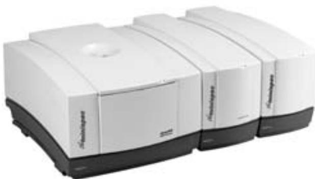
**Figure 15.30** Appareil de RMN<sup>1</sup>H basse résolution destiné aux analyses de routine. Analyseur fonctionnant sur le principe de la RMN impulsionnelle, utilisé pour quantifier l'eau et les matières grasses de nombreux produits agroalimentaires (modèle Minispec, reproduit avec l'autorisation de la société Bruker).
