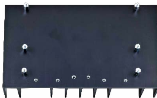
Rysunek 13. Gotowe otwory do montażu tranzystorów mocy
