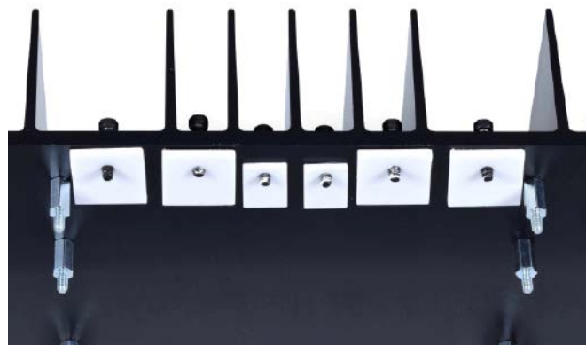
Rysunek 21. Ceramiczne podkładki są pokryte z jednej strony cienką warstwą pasty termicznej i zamontowane nad częściowo włożonymi śrubami. W tym celu radiator musi być ustawiony pionowo
