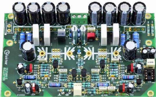
Rysunek 16. Dwa kołki dystansowe prowadzące z K3 do K6 i z K4 do K7 znajdują się na środku płytki wzmacniacza, obok siebie
