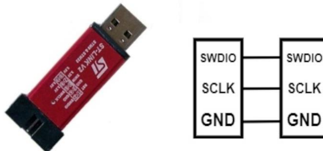
Rys. 7.2 – Programator STLINK V2 (SWD) i schemat połączeń
