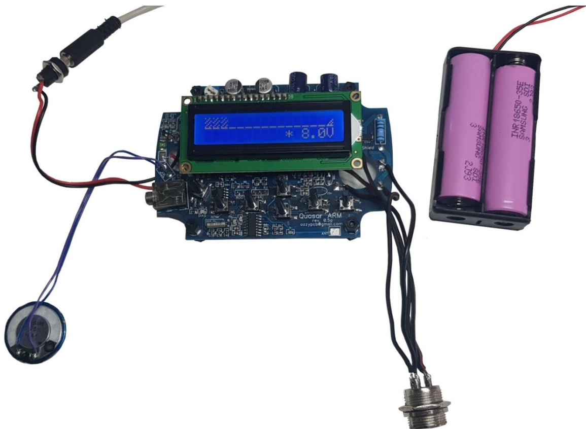
Rys. 4.1 - Blok elektroniki urządzenia wraz z zasilaniem
