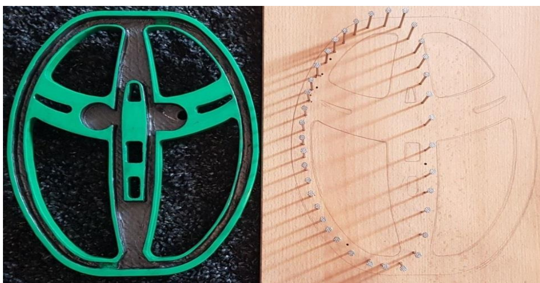
Rys. 6.5 – Obudowa sondy pokryta lakierem grafitowym, obok sporządzone na jej podstawie kopyto do nawijania cewek
