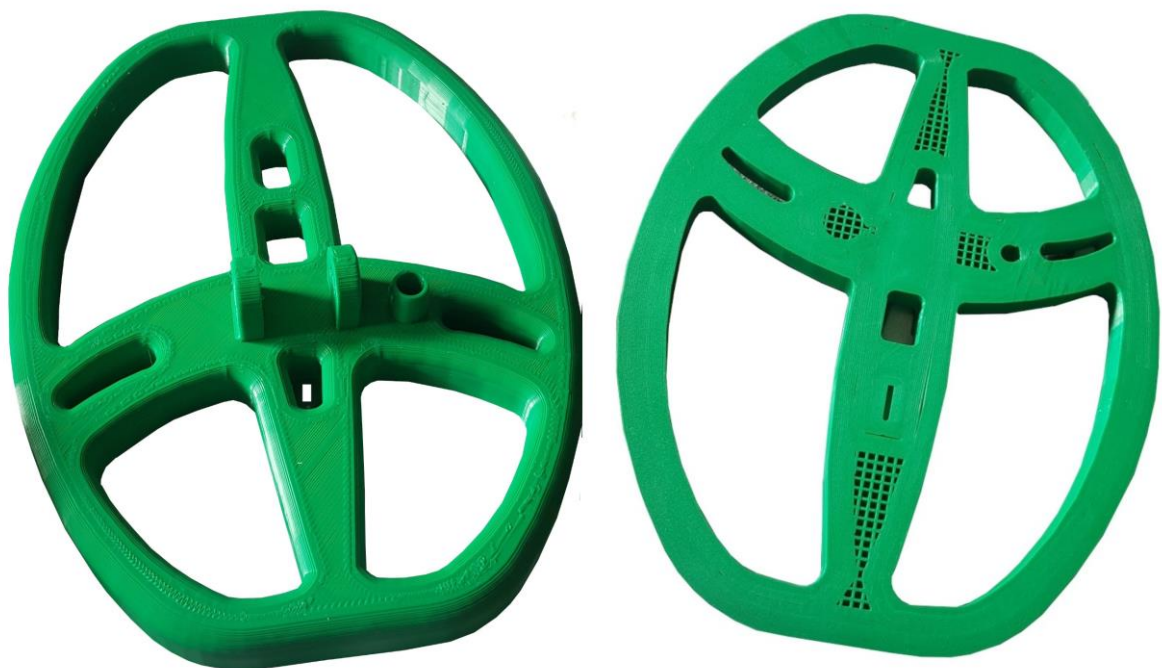
Rys. 6.1 – Góra i dół obudowy sondy po wydrukowaniu, przed usunięciem podpór
