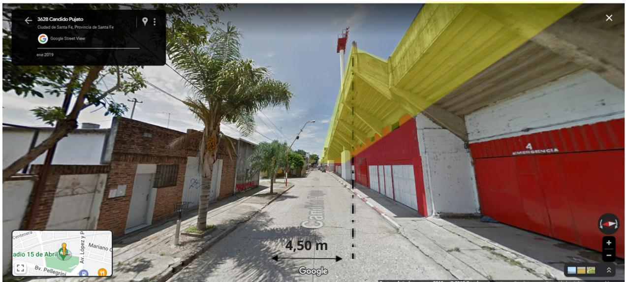
IMAGEN N°21: Distancia desde la proyección vertical de la arista "B" a nivel de pavimento hasta el colector cloacal. Se destaca que, en el proyecto de ampliación y modernización del estadio y lateral norte del Club Unión, se contempla el "recorte" de la tribuna Pujato para alcanzar una altura y un desarrollo uniforme (correspondiente al sector de menor altura).
