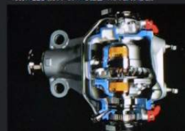
アクティブLSD (カットモデル、撮影のための部分着色)
