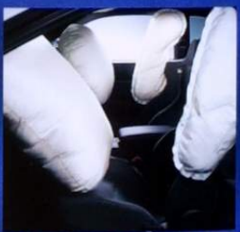
運転席・助手席SRSエアバッグシステムA運転席・助手席SRSサイドエアバッグシステム(メーカーオプション)
