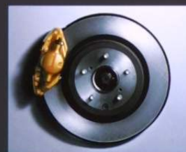
brembo社製リアブレーキ(N1仕様大径ディスクローター)
