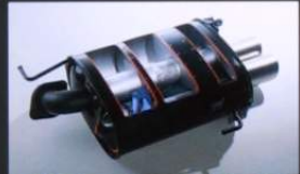
排圧感応型制御マフラー(カットモデル、撮影のため部分着色)
