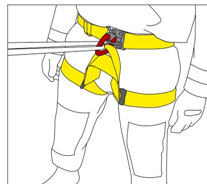
Auto évacuation d'urgence: le ceinturon et la sangle rassemblés par un mousqueton, deviennent un baudrier permettant une évacuation d'urgence.
