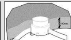
Instalação no pavimento de betão
