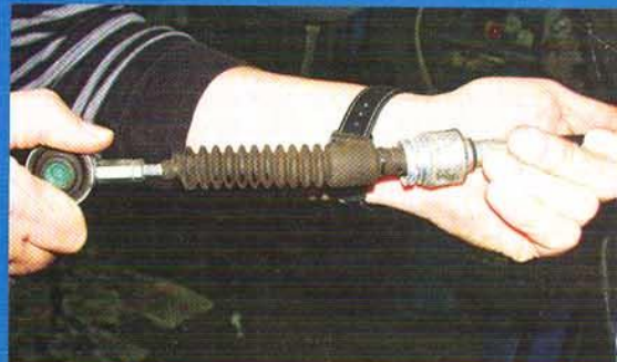
Ovo potezno čelično uže („sajla“) zahteva jaču silu. To objašnjava delimično teži hod menjača
