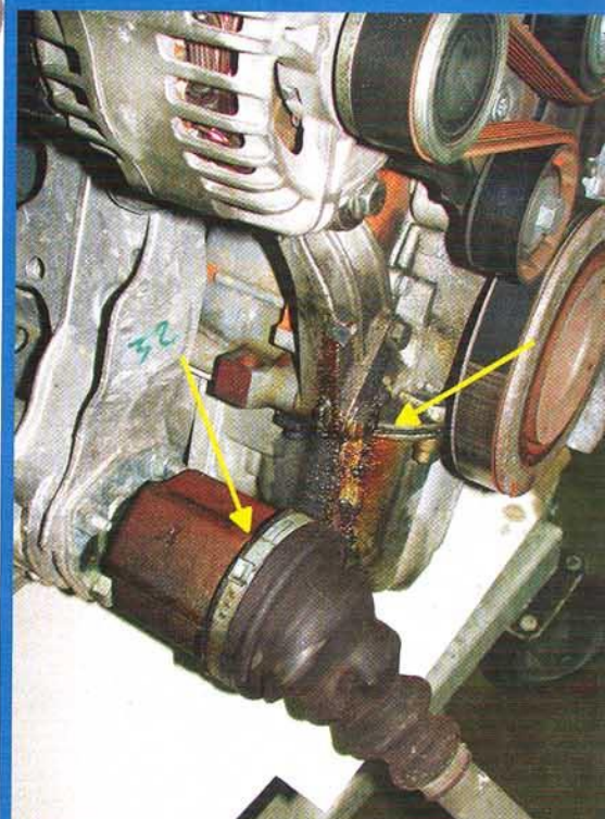
Zaptivanje pogonskih vratila je isuviše slabo. Mast curi i usled rotacije biva razbacana na okolne agregate
