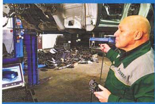
U oba praga je pomoću endoskopa otkrivena voda - ali ne i korozija
