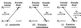
Fig. 2-37. Procesos radiativos: (a) absorción; se absorbe un fotón incidente; (b) emisión espontánea; se produce un fotón; (c) emisión estimulada bajo la acción de un fotón incidente.
