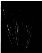
Fig. 8-6. Trazas de partículas \alpha en una cámara de niebla. La traza desviada parece deberse a la reacción ^{14}\text{N}(\alpha, p)^{13}\text{O} que ha tenido lugar con un átomo de hidrógeno de la cámara. Dos grupos de partículas \alpha , cada uno con un alcance característico, son fácilmente reconocibles en esta fotografía.
