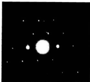
Fig. 1-22. Difracción de electrones de 80 kV en un monocristal de carbono (grafito) (cortesía de R. Heidenreich, Bell Telephone Laboratories).
