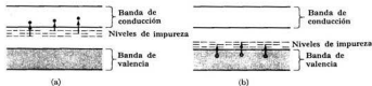
Fig. 6-40. Impurezas en un semiconductor: (a) dadoras o tipo n, (b) aceptadoras o tipo p.
