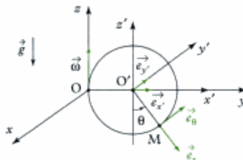
Schéma 2 : cas où le plan de la circonférence ( \mathcal{C} ) est confondu avec le plan ( yOz ).
